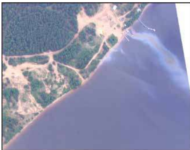
Рис. 7.7. Авиационный фотоснимок с высоты 1 км разлива нефти в акватории
