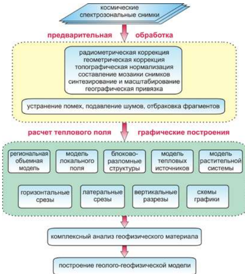
Рис. 2.14. Схема обработки космических спектрозональных тепловизионных снимков
